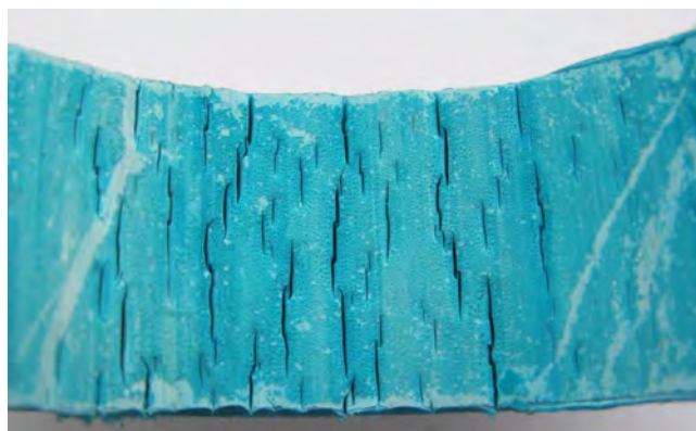
Die Abbildungen zeigen chemische Reaktionen nach langer Standzeit, die auftreten, wenn ein thermoplastischer Werkstoff gewählt wurde, der nicht für die beförderte Flüssigkeit geeignet ist.
