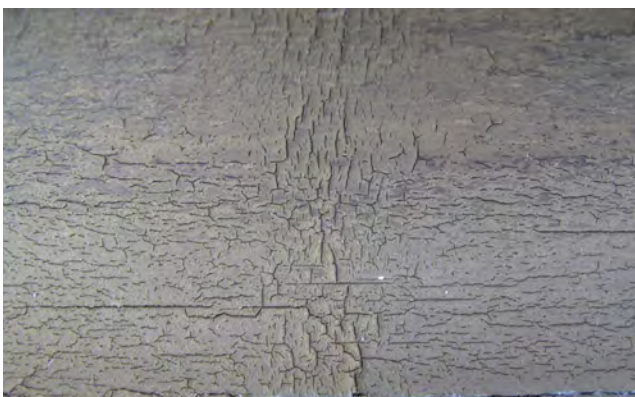
Die Abbildungen zeigen chemische Reaktionen nach langer Standzeit, die auftreten, wenn ein thermoplastischer Werkstoff gewählt wurde, der nicht für die beförderte Flüssigkeit geeignet ist.
